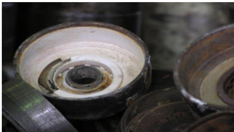
2.5 Сурет – ОТСҚ сорғысының доңғалақ аппараттарындағы қатты шөгінділер
