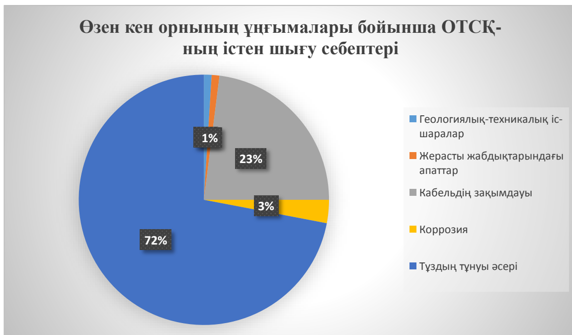
2.4 Сурет – Өзен кен орнының ұңғымалары бойынша ОТСҚ-ның істен шығу себептерінің үлестері
