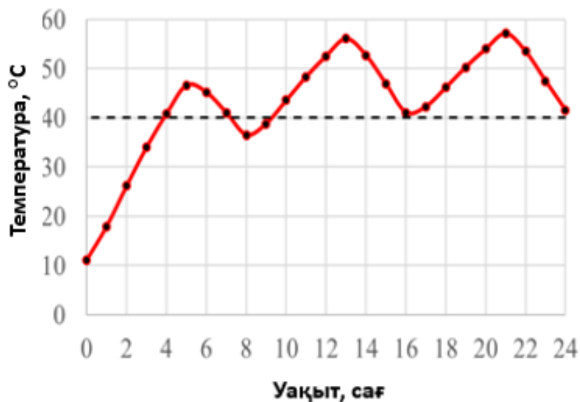
4.16 Сурет – 5/3 жылыту кабелінің жұмыс режимі кезінде ұңғыманың сағасындағы температураның таралуы
