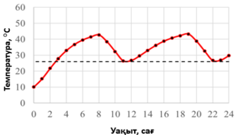
4.18 Сурет – 8/3 жылыту кабелінің жұмыс режимі кезінде ұңғыманың сағасындағы температураның таралуы
