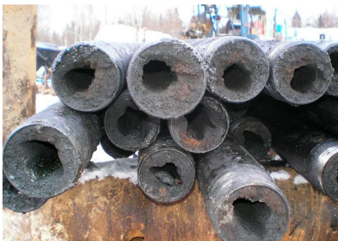
4.1 Сурет – Асфальтты-шайырлы-парафинді шөгінділер
