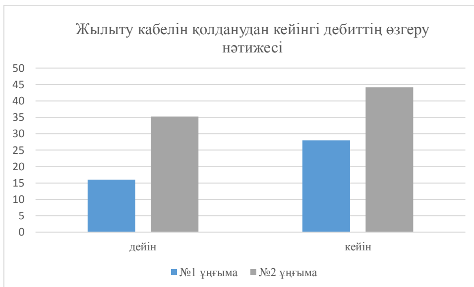
4.19 Сурет – Жылыту кабелін қолданудан кейінгі дебиттің өзгеру нәтижесі
